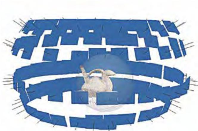
Figura 15: Recorrido fotográfico realizado para el proceso de fotogrametría
