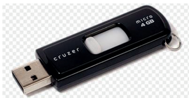
Figura 20. La memoria USB (Universal Serial Bus), conocida también con los nombres locales: USB, memoria externa, pendrive, entre otros, es un dispositivo de almacenamiento de datos que utiliza circuitos de estado sólido para guardar información.
