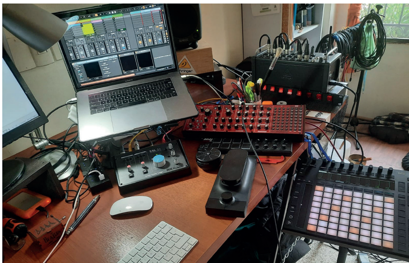
Imagen 16. De izquierda a derecha: patcher de Ableton en la computadora, debajo SSL 2+, en rojo el neutrón de la Behringer, delante el Expressive Touché SE y en el atril a la derecha el Push de Ableton.
