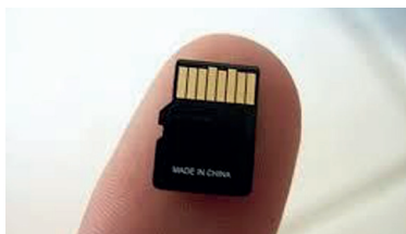
Figura 21. La tarjeta SD (Secure Digital) es una pequeña tarjeta de memoria que almacena información en dispositivos portátiles: teléfonos móviles, cámaras digitales o tabletas. Se caracterizan por sus medidas muy pequeñas, su capacidad para almacenar y la velocidad a la que transmiten y copian los datos.
