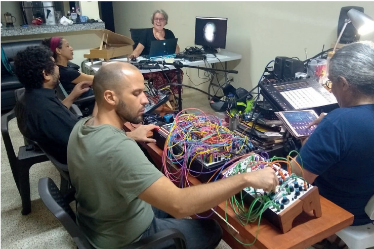
Imagen 9. Ensayos y planificación. Módulos de Campoverde: el primer case (negro) es un sistema modular formato Eurorack, allí constan 3 VCO, 1 Secuenciador, 1 VCF, 8 VCA, 5 Envelope Generators, 6 LFO, 1 Sample & Hold, 1 Low Pass Gate doble, 1 distribuidor de Clock, 1 Sampler. El segundo case es formato Buchla, allí se ve 1 VCO, 2 generadores de funciones, 2 Low Pass Gate/VCA, 1 módulo Utilities para convertir señales de formato Eurorack a formato Buchla. Foto de Cheung.
