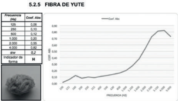
Figura 33: coeficiente de absorción de yute obtenido de Cazorla y Córdoba. 13
