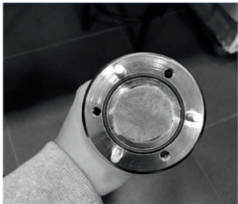
Figura 22: muestra de lana de roca en el tubo de Kundt.
