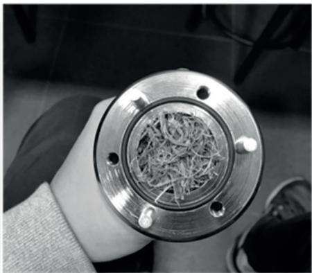
Figura 15: muestra de cáñamo en el tubo de Kundt.
