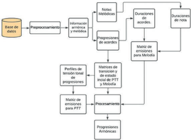
Figura 1: diagrama de flujo para el entrenamiento de los modelos.
